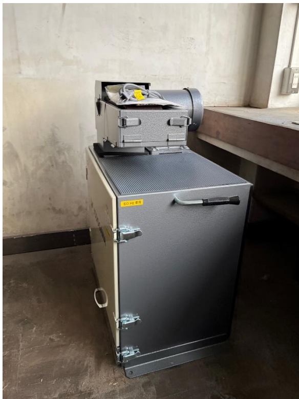
試験材料を磨くための 「ベルトグラインダー」 機械系研削室に設置
